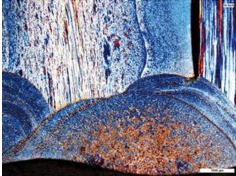
Figura 2.2.66. Colorazione di diverse zone di grana o cristalli misti e strati di solfato di diverso spessore - Collegamento tramite saldatura laser di vari fili di acciaio austenitico (B) (fonte: Leica Microsystems)
