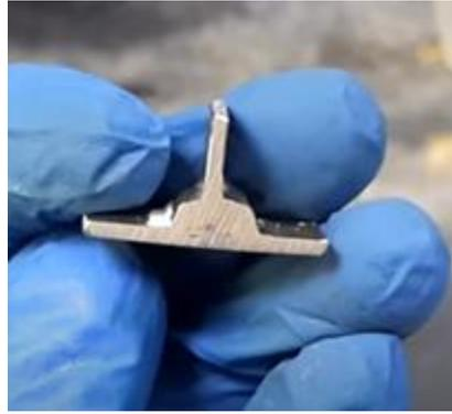
Figura 2.2.33. Preparazione del campione per l'incisione a colori (fonte: Vac Aero Coloured Metallography)
