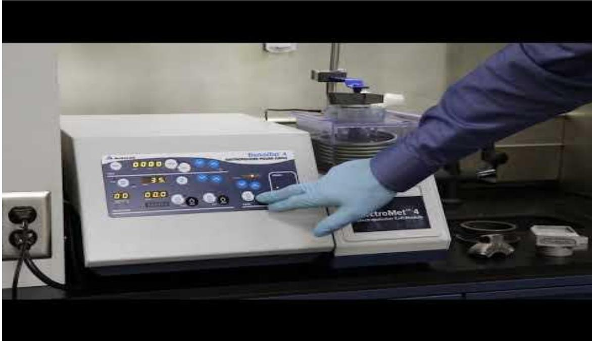
Figura 2.2.30. Demo di lucidatura e incisione di ElectroMet 4 (fonte: BuehlerMaterials)
