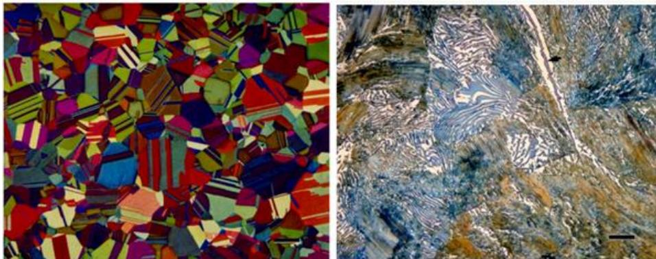
Figura 2.2.52.e 2.2.53: micrografia a cartuccia in ottone mostrata nelle figure 2.2.11 e 2.2.12, tinta incisa con il reagente PbS di Beraha (a sinistra) e cementite in una lega binaria Fe-1% C laminata a caldo colorata con il reagente al molibdato di sodio di Beraha (a destra). Le barre di ingrandimento sono rispettivamente 200 e 20  $\mu\text{m}$ ,(fonte: Metallografia colorata Vac Aero)
