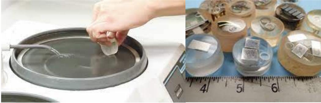
Figura 2.2.42. Preparazione del campione ed esempio del campione (fonte:Kemet Internazionale Ltd)
