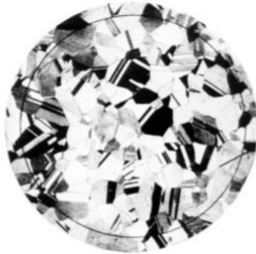
Fig. 2.3.9– esempio di grana doppia (incisioni a contrasto) dalla tavola III – Granulometria 4 a 75X – immagine tratta da ASTM E112. Fonte: [2.3.6] ASTM E112 – Metodi di prova standard per la determinazione della dimensione media del grano
