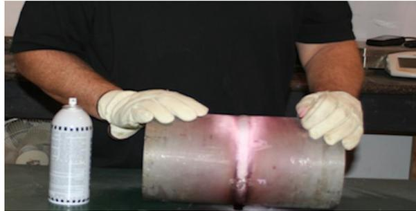
Fig. 1.3.28: Test con liquidi penetranti [1.3.37]
