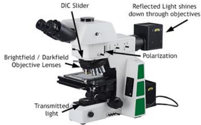
Figura 2.2.62. Microscopi metallurgici (fonte: Nikon)
