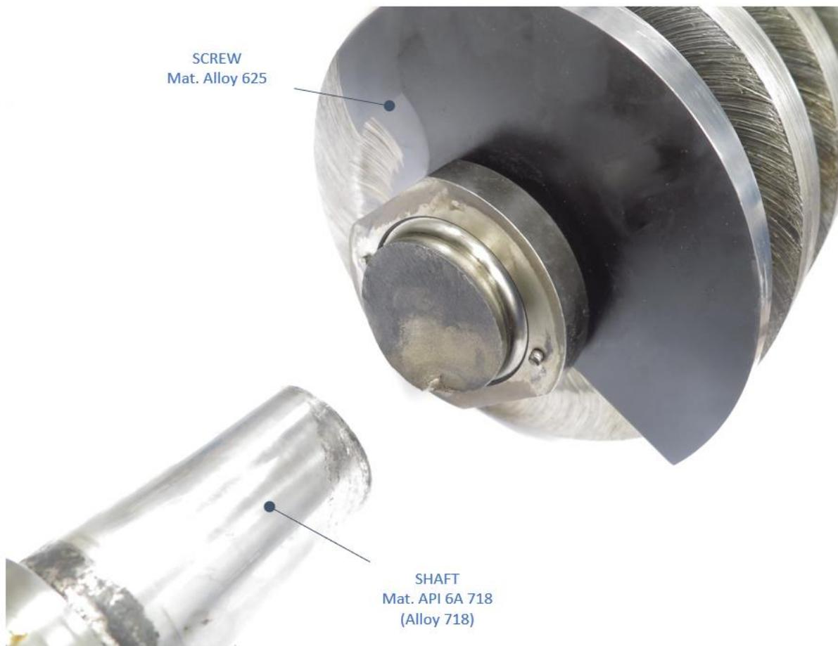
Fig. 2.6.5 – Esempio di albero in lega di nichel fratturato da fenomeni di fatica. Fonte: Laboratorio IIS.
