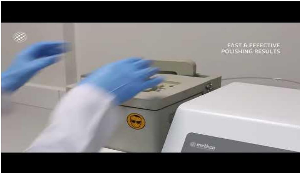
Figura 2.2.29. Sistema di lucidatura e incisione elettrolitica (fonte: Metkton USA)
