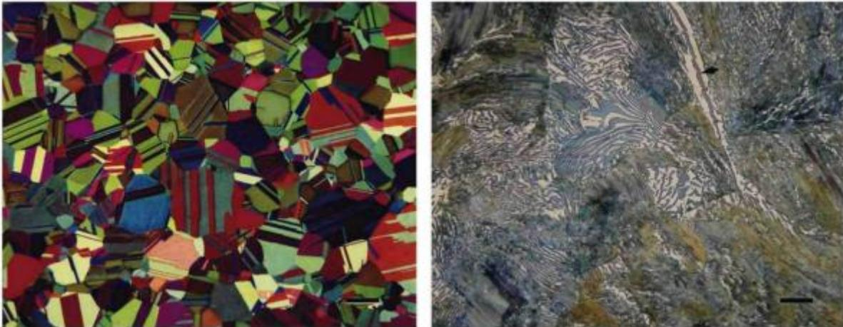
Fig. 2.1.29 e 2.1.30: Micrografia a cartuccia in ottone mostrata nelle Figure 2.1.22 e 2.1.23 tinta incisa con il reagente PbS di Beraha (a sinistra) e cementite in una lega binaria Fe-1% C laminata a caldo colorata con molibdato di sodio di Beraha reagente (a destra). Le barre di ingrandimento sono lunghe rispettivamente 200 e 20  $\mu\text{m}$  [2.1.14].
