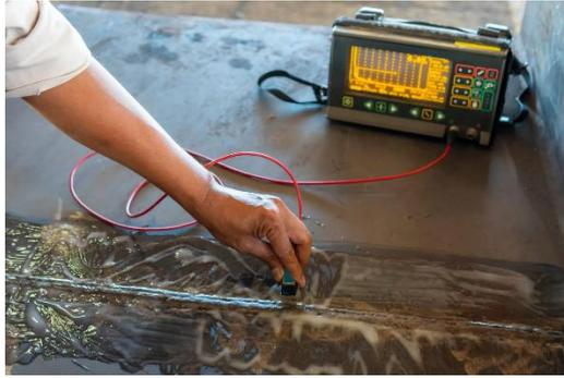
Fig. 1.3.25: Controllo ad ultrasuoni della saldatura [1.3.34]
