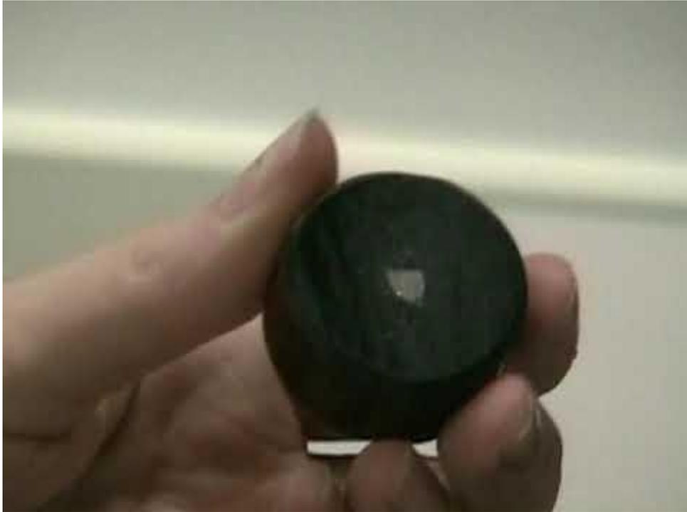
Video 3.2.3: Preparazione del campione per metallografia.
