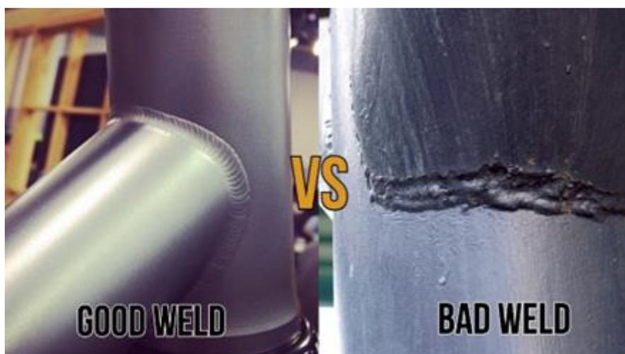
Fig. 3.2.32: Differenza tra saldatura buona e cattiva, esempio 1. Fonte: <https://waterwelders.com/good-weld-vs-bad-weld/>
