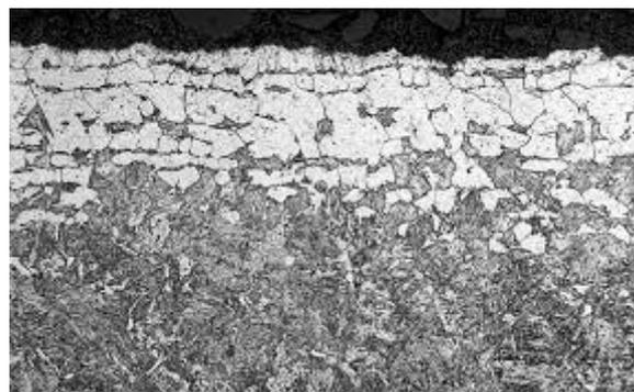
Figura 3.6.3. Superficie decarbonizzata dell'acciaio C-Mn
