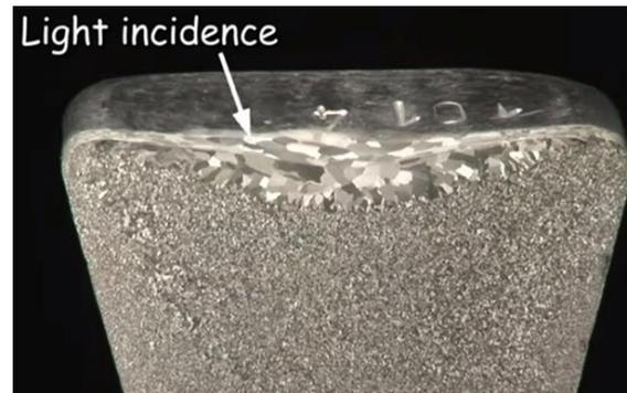
Fig. 2.1.41 Valutazione del limite del grano dopo la lucidatura chimica per l'acciaio inossidabile
