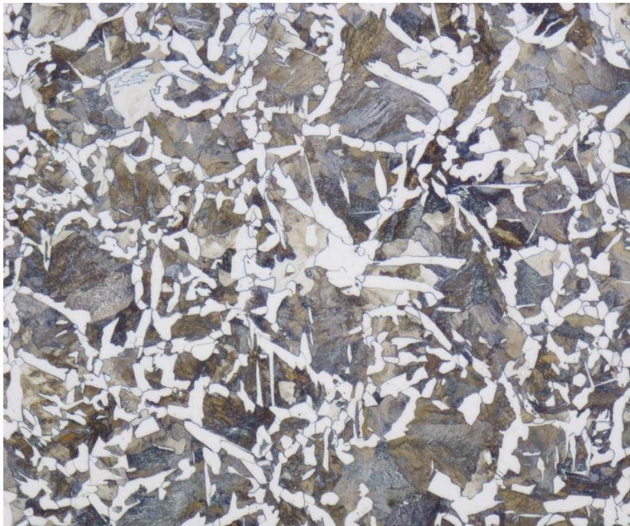
Fig. 3.5.5 – Dettaglio di un acciaio a medio carbonio tipo C45 (C = 0,45 % peso) – Perlite isolate di ferrite. Acquaforse: Nital 2%. Fonte: Laboratorio IIS.
