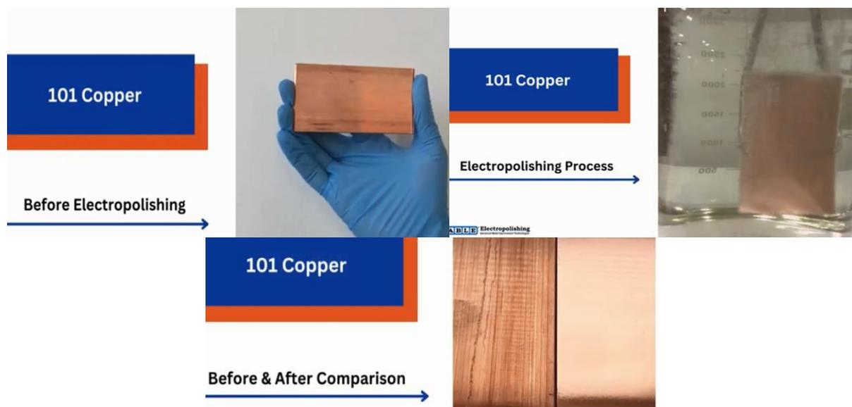
Fig. 2.1.37 Rilevamento dei difetti superficiali prima e dopo la lucidatura elettrolitica per il rame 101 [2.1.16]
