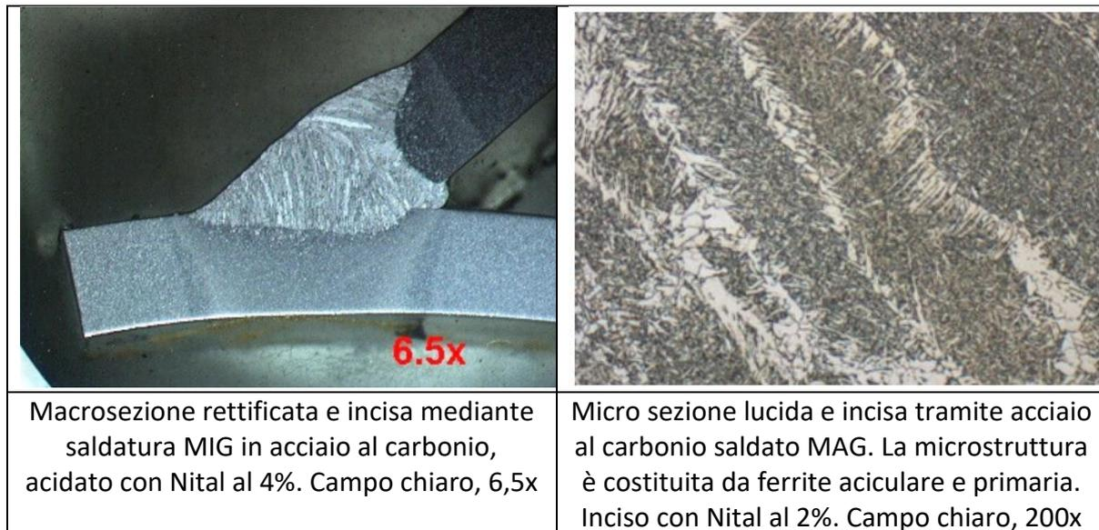
Fig. 2.1.14 Acciaio al carbonio prima e dopo l'attacco chimico [2.1.10]
