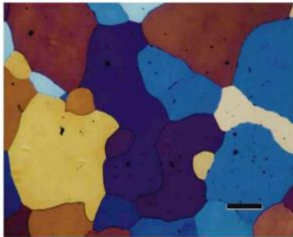
Fig. 2.1.21 L'orientamento del cristallo anodizzato di alluminio superpuro è evidenziato con il reagente Barker (30 Vcc, 2 minuti). La barra di ingrandimento è lunga 200  $\mu\text{m}$  [2.1.14]
