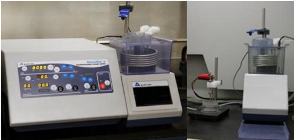
Figura 2.2.4. Attrezzatura per lucidatrice elettrolitica con scopri cella elettrolitica
