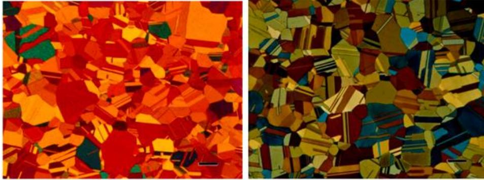
Figura 2.2.44. E Figura 2.2.45. Struttura a grana gemellata FCC di cartuccia in ottone, Cu - 30% Zn, dopo riduzione a freddo del 50% e ricottura completa, tinta incisa con i reagenti di Klemm I (a sinistra) e III di Klemm (a destra) e visualizzata con luce polarizzata più tinta sensibile. Le barre di ingrandimento sono lunghe rispettivamente 200  $\mu\text{m}$  (fonte: Metallografia colorata Vac Aero)
