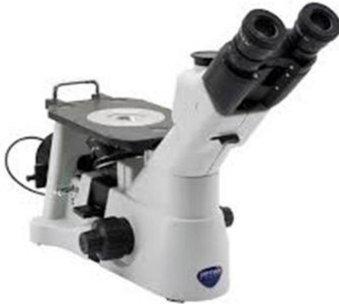
Figura 2.2.38. Microscopio metallografico (fonte: Olympus)
