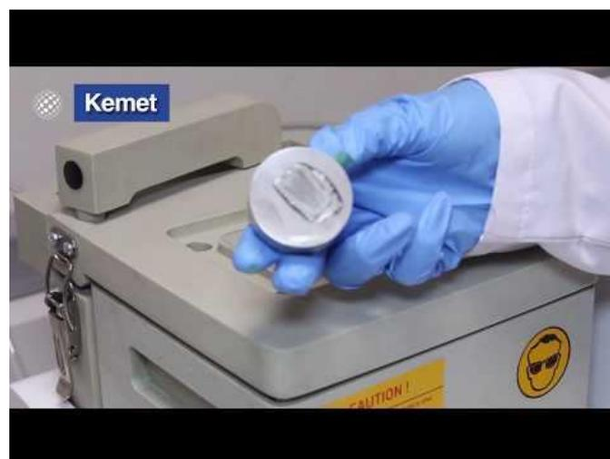
Fig. 2.1.3 Lucidatura della preparazione elettrolitica del campione [2.1.3]
