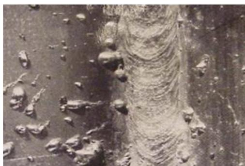
Figura 3.2.10. Caratteristiche visive degli schizzi. Fonte: MS Rogers, Riferimento al corso Ispezione difetti/riparazioni di saldatura WIS 5, 2003.
