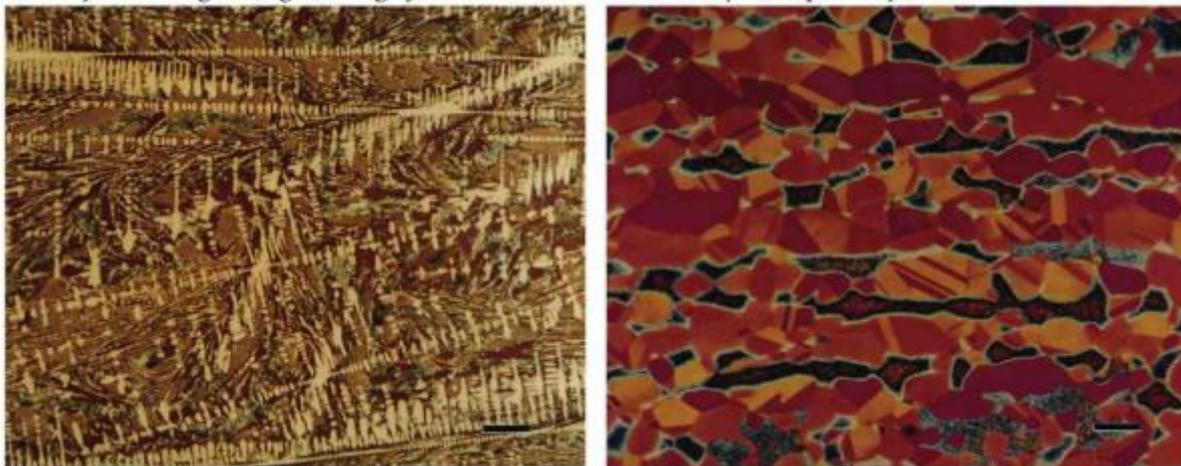
Fig. 2.1.31 e 2.1.32: Cementite nella superficie di fusione in conchiglia di ghisa grigia incisa con il reagente acido selenico di Beraha per ghisa (a sinistra) e fase alfa e fase beta FCC gemellate (chiazze e delineate) in Cu-40% Zn rivelato utilizzando il reagente acido selenico di Beraha per le leghe di rame. Le barre di ingrandimento sono lunghe rispettivamente 50 e 20  $\mu\text{m}$  [2.1.14].
