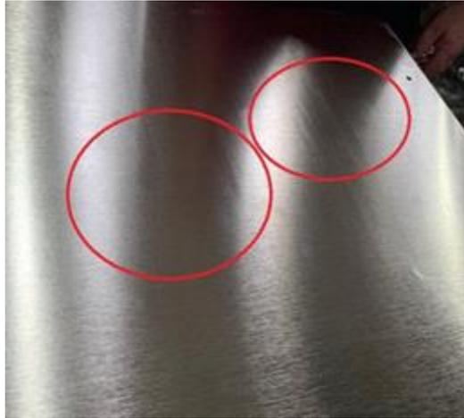
Figura 2.2.14. Lucidatura disomogenea su lamiera inox (fonte: AzOm)
