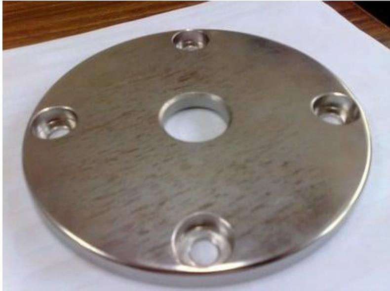
Figura 2.2.19. [Striature su SS304 lavorato dopo elettrolucidatura](#) (fonte: Global Spec)
