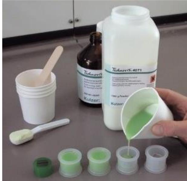
Figura 3.3.1.3. Esempio di processo di montaggio a freddo
