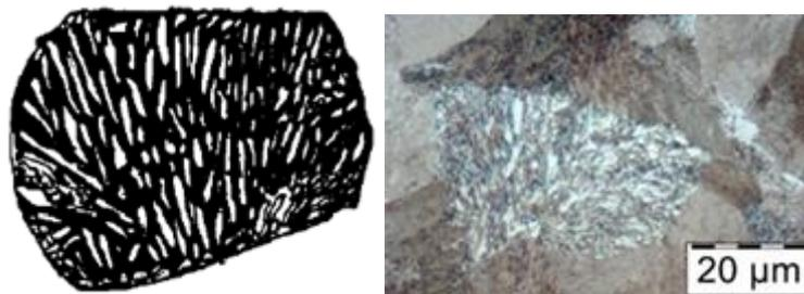
Figura 3.1.1. Campione di acciaio ricotto. Fonte: <https://sim.tuiasi.ro/wp-content/uploads/2015/03/MF1-Laboratoare.pdf>
