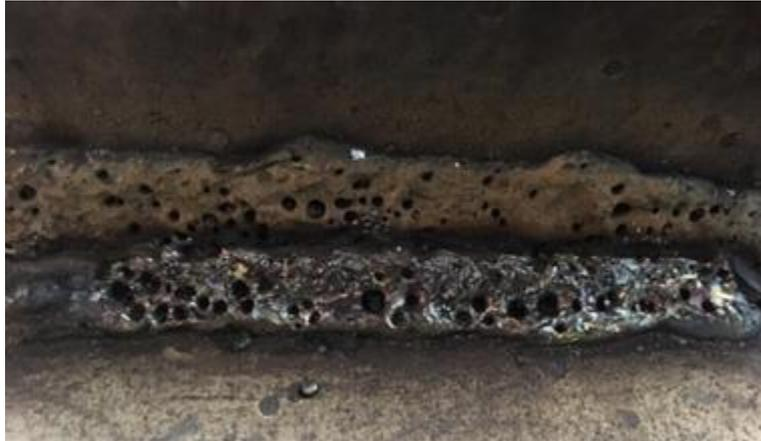
Fig. 3.2.27: Porosità. Fonte: <https://www.mechanicwiz.com/porosità-in-saldatura/>
