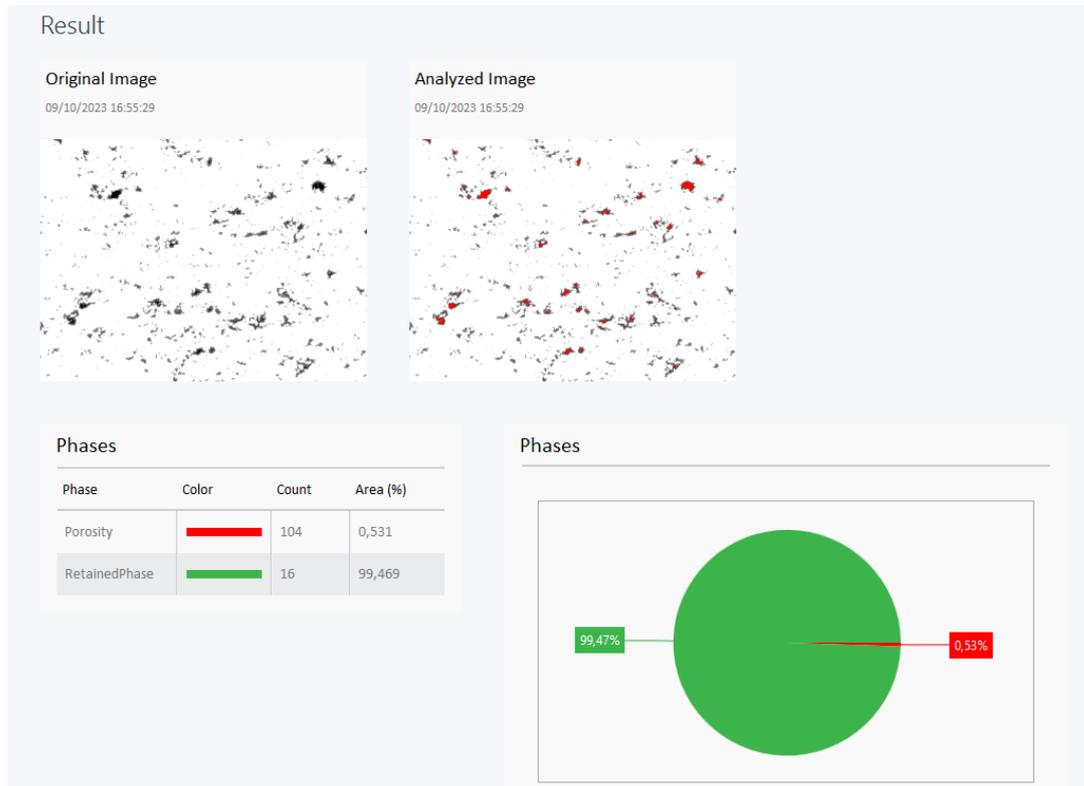
Fig. 2.4.10– Dettaglio di un report ottenuto dal programma di analisi di immagini. La percentuale di porosità sul rivestimento a spruzzo termico è di circa lo 0,53%. Fonte: Laboratorio IIS.
