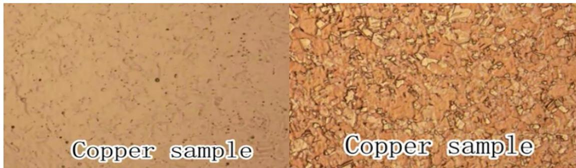
Fig. 2.1.40 Valutazione del limite del grano dopo la lucidatura elettrolitica per il rame 101
